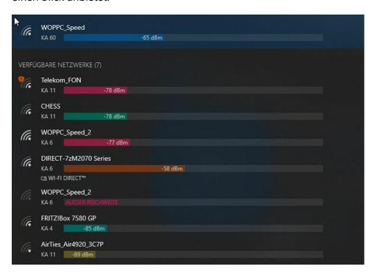
Nach der Installation können Sie sie sich durch einen Klick auf das WLAN-Symbol oben links in der Symbolleiste eine Übersicht der empfangbaren WLANs und der Dämpfungswerte an. Der Dämpfungswert gibt Aufschluss darüber, wie stark der Empfang ist beziehungsweise wie beeinflusst das WLAN-Signal durch Ihre Empfangsposition ist, beispielsweise durch Wände. Ein niedrigerer Dämpfungswert ist also positiv!
