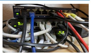
Kabeln. Mit einem Netzwerkkabel gehen Sie dann vom Router zu einem zentralen Punkt, wo sich viele Geräte finden. Der Router übernimmt dann die Verteilung des Netzwerkverkehrs auf die einzelnen Geräte. Ouasi eine Mehrfachsteckdose für das Netzwerk.
